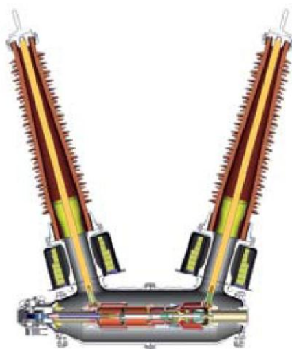
شکل (۱-۳۶): ساختمان یکی از فازهای سوئیچگیر فشرده
