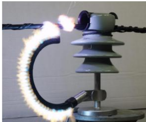
شکل (۱-۱۵): برقگیر چند محفظه‌ای برای حفاظت بر خورد غیر مستقیم صاعقه و حفاظت اضافه ولتاژ القایی
